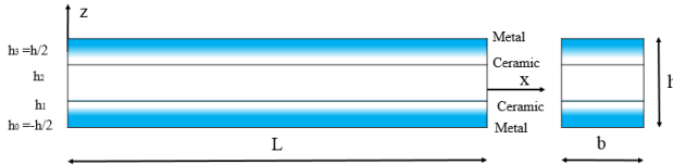
(b) Loại B: Dầm phân lớp chức năng với lớp mặt là vật liệu FG và lớp lõi là vật liệu đồng nhất.
